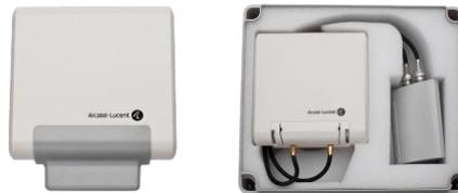
Los puntos de acceso 8340 IP DECT pueden montarse en la pared y en el techo y están disponibles con dos referencias, una para la versión con antena interna y otra para conectar una antena de ganancia externa mediante conectores SMA. Consulte el catálogo y la información técnica para obtener la lista de antenas compatibles. Se puede utilizar carcasa dedicada para instalar el punto de acceso 8340 IP DECT en el exterior.
